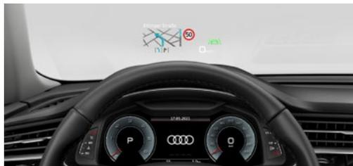
projiziert auf Wunsch die Geschwindigkeit und weitere fahrerrelevante Informationen aus Navigation und optional erhältlichen Assistenzsystemen sowie Warnhinweise in den direkten Sichtbereich des Fahrers; in Höhe einstellbar; ermöglicht kontraststarke, mehrfarbige Anzeige mit reduzierter Blickabwendung von der Fahrbahn
